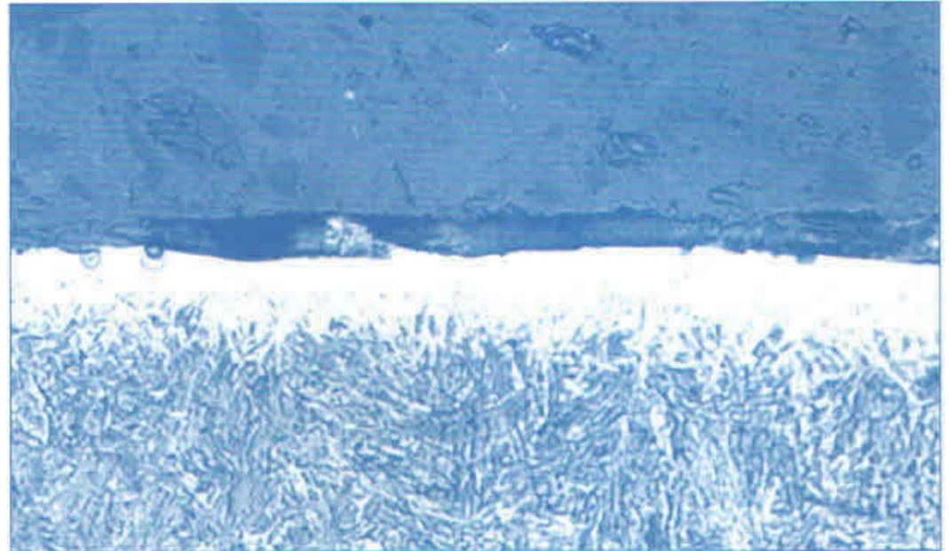
Micrografía de la estructura metalográfica de una zona sobrecalentada. La estructura dúctil original del acero (como en la mitad inferior de la imagen) se templó de nuevo y adoptó el aspecto característico de la martensita dura, frágil y sin revenir.
